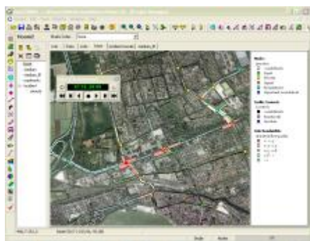
Pohled na dynamický model ukazující proměnné hustoty dopravy a průběh front před křižovatkami
